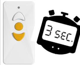
Appuyer sur « **STOP + DESCENTE** » pendant « **3 sec** » et relâcher, le volet fait un mouvement de va et vient.
