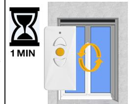
Dans la minute qui suit l'alimentation, appuyer sur le bouton « **STOP** » 0,5 sec, le volet fait un mouvement de va et vient, régler à nouveau les fins de courses (étape 3).
