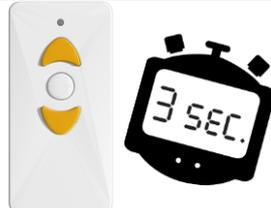
Appuyer simultanément sur « **MONTEE** » et « **DESCENTE** » pendant « **3 sec** », le volet fait un mouvement de va et vient.
