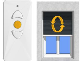
**Dans la minute qui suit l'alimentation,** appuyer sur le bouton « **STOP** » **0,5 sec**, le volet fait un mouvement de va et vient, et vérifier le sens de rotation.
